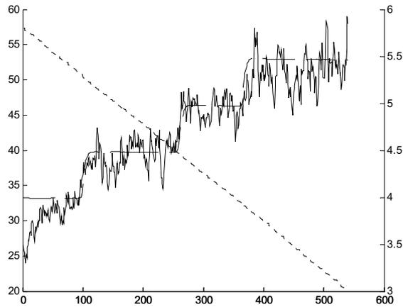
Fig.3. air velocity (--), signal RMS (-) and solid mass (...)
